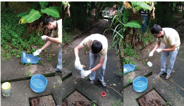
Imagem 1. Coleta de amostra de água da galeria pluvial.
