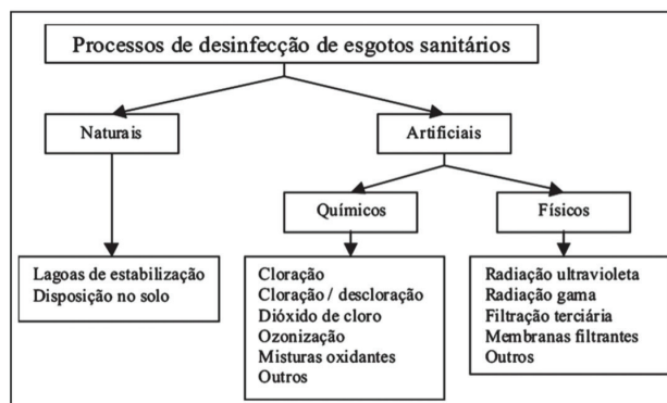
Imagem 6. Processos de desinfecção de esgotos sanitários. Fonte: Gonçalves (2003 apud GONÇALVES et al., 2006, p. 187).
