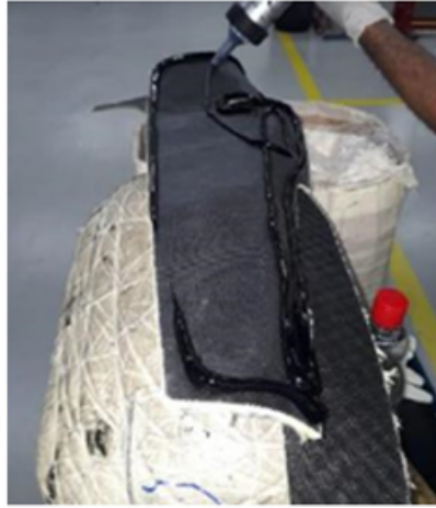
Figura 6 – Peça sendo preparada com Manta de Aramida
