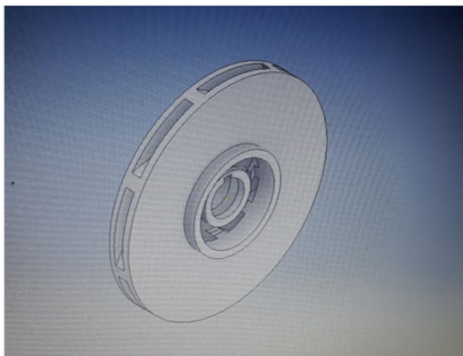
Figura 6. Modelamento do rotor em Autodesk INVENTOR®.
